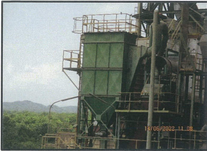
รูปที่ 1 ระบบบำบัดฝุ่นแบบถุงกรอง (Bag Filter)
