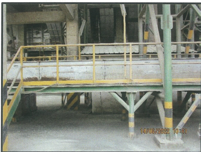
รูปที่ 8 ระบบสายพานลำเลียงฝุ่นแบบปิด
